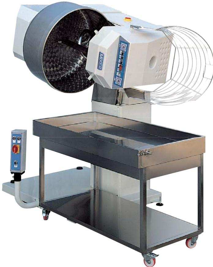
Il sistema ASM/RB MIXER offre una risposta efficace all'artigiano panettiere e pasticciere che vede crescere i volumi di produzione e le varietà di prodotto. Il sistema ASM/RB è costituito da un sollevatore ad ingombro ridotto applicato ad una impastatrice a spirale della linea ASM e permette di semplificare le operazioni di scarico della pasta su banco da lavoro dove eseguire le lavorazioni manuali.
